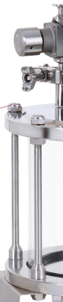
**Tensionamento de porca dupla para fácil montagem/desmontagem**
